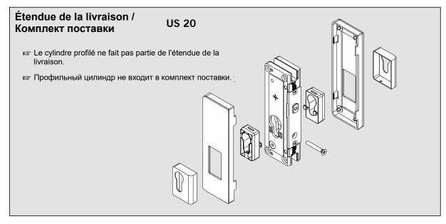
Notice de pose – US 10 Serrure d'angle / US 20 Serrure centrale, pour cylindre profilé européen / Инструкция по монтажу – US 10 угловой замок / US 20 центральный замок, с профильным цилиндром
