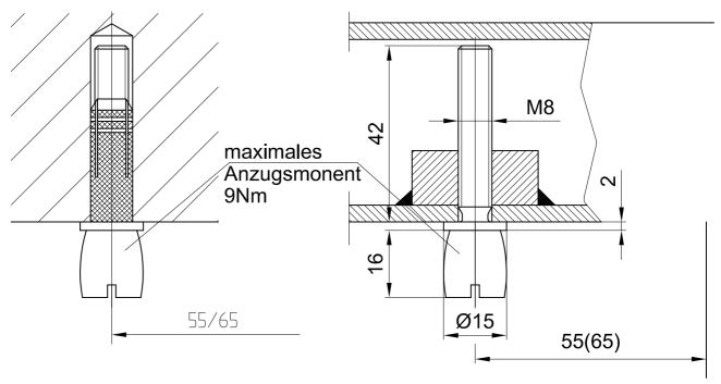
Art. Nr. 01.116 PT 24 Zapfen Ø15 mm mit Anschraublasche (Ausführung: LM)
