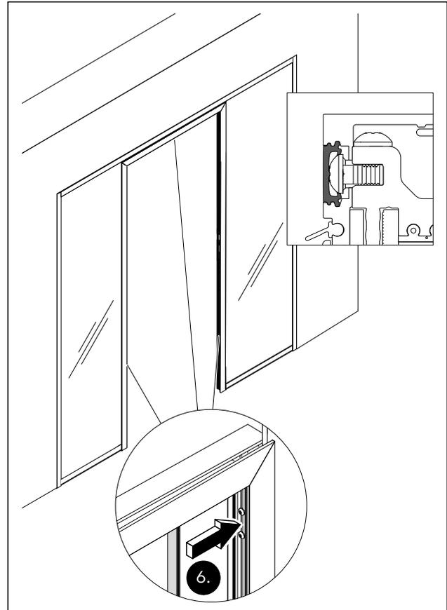
Abb. 44 Die inneren Silikondichtungen über den Schrauben im Durchgang anbringen.
