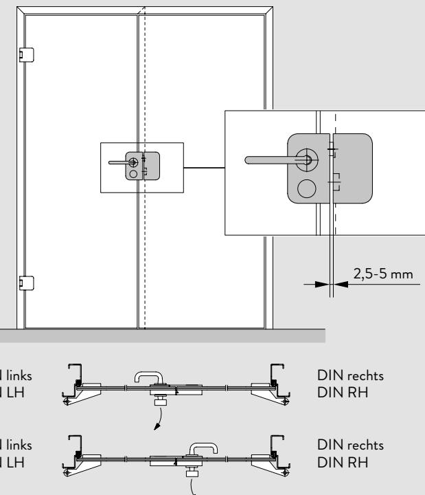
Vor der Montage Glasflächen mit handelsüblichem Glasreiniger im Bereich der Klemmflächen reinigen.
